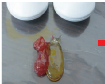
主剤と硬化剤を同量出す。
